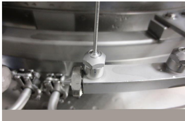
Derouging an Vials-Waschmaschine in Zirkulation
