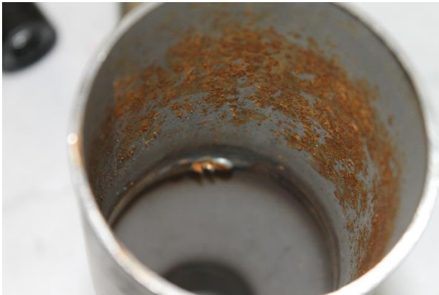
Dekontaminationsanlage mit Korrosion und Produktresten in Zirkulationsbehandlung
