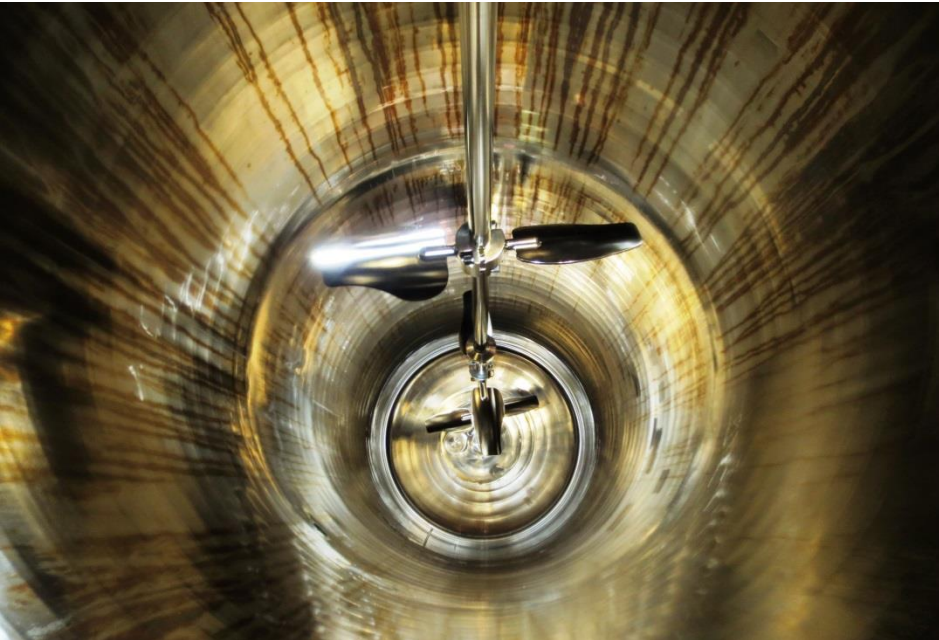
Aufnahme eines Reaktionsbehälters mit Produktresten und Rouging vor und nach einer Reinigung
