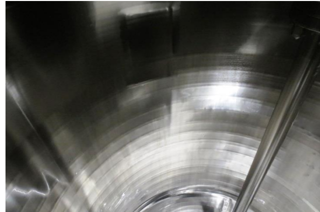
Derouging an 15 m 3 Tank im Zirkulationsverfahren
