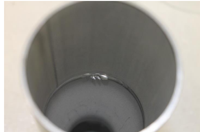
Dekontaminationsanlage mit Korrosion und Produktresten in Zirkulationsbehandlung
