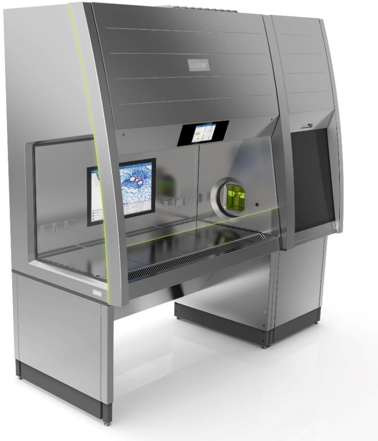
Zytostatika-Sicherheitswerkbank DIN 12980 SealSafe Foliensack-Einschweissgerät Berührungsfreie Glasscheibenschleuse Kontaminationsarmer Filterwechsel
