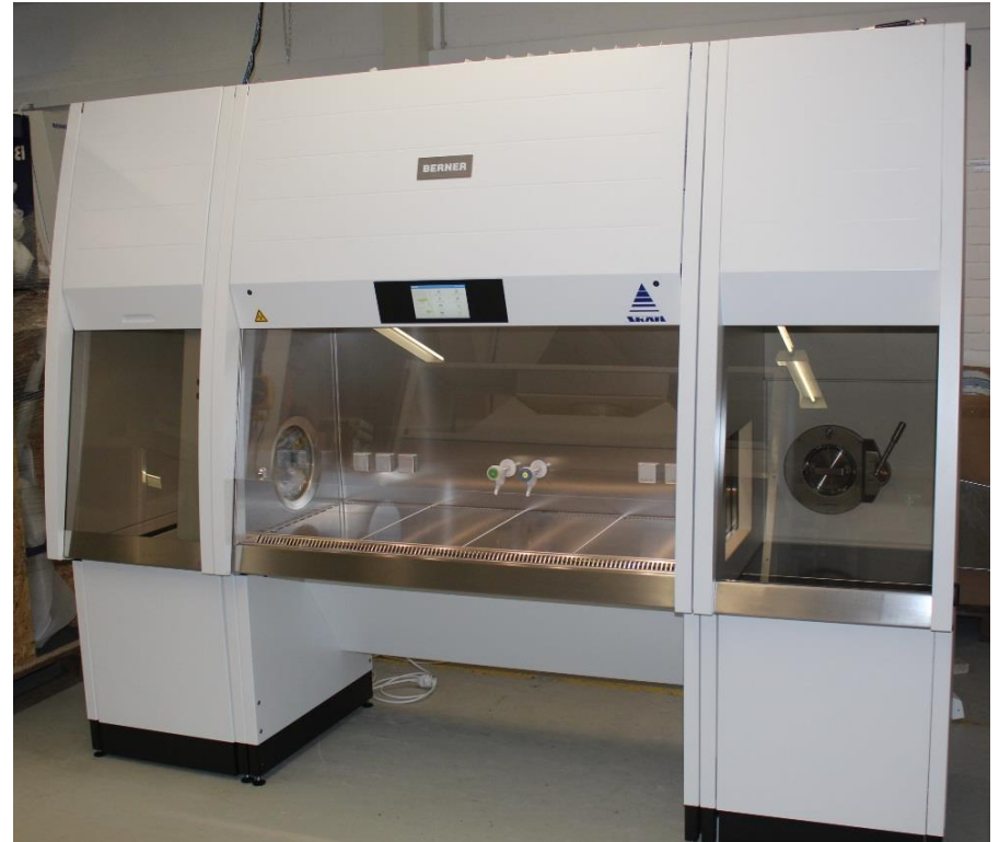
Zytostatika-Sicherheitswerkbank DIN 12980 SealSafe Foliensack-Einschweissgerät Durchreiche Transferschleuse mit RTP-Port Kontaminationsarmer Filterwechsel
