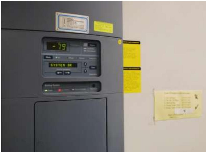
In diesem Beispiel existierte kein getrenntes Monitoring für den Ultratiefkühlschrank. Der Regelsensor des Schrankes wurde auch zu Monitoring- und Alarmzwecken verwendet.
