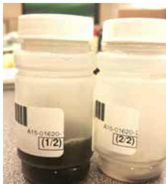
Wasser-Waschflüssigkeit nach Kontakt mit M6 Kombinationsmedien (links), gegenüber derselben Flüssigkeit nach Kontakt mit GTC-Medien nach 1.000 Stunden Turbinenbetrieb.
