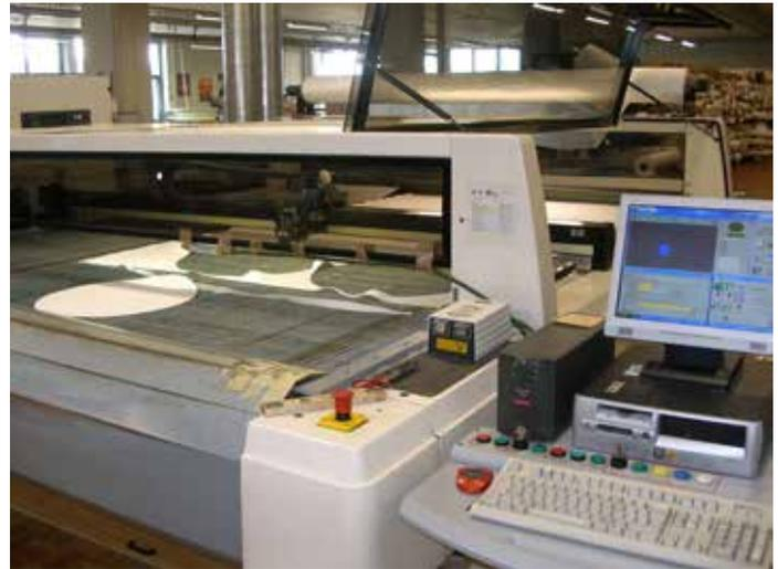
Lasercutter CAD-gesteuert. Schnittbreite bis 248 cm.
