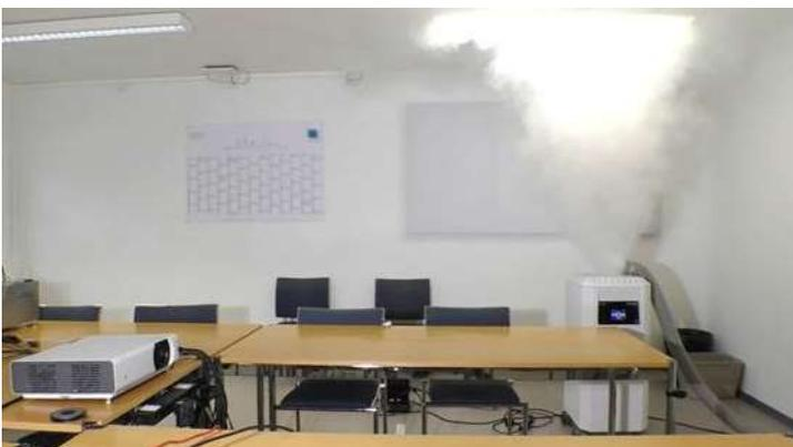
*Abb. 1 Strömungsvisualisierung zur Darstellung der Luftausbreitung und zur Prüfung, ob visuell ein Kurzschluss erkennbar ist.*
