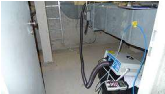
Bild 2: Messaufbau im nur circa 1m hohen Kriechkeller unter dem S3-Labor.
