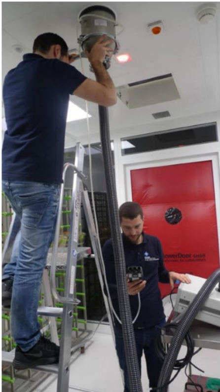
Prüfung Leckluftvolumenstrom an Einzelkomponente
