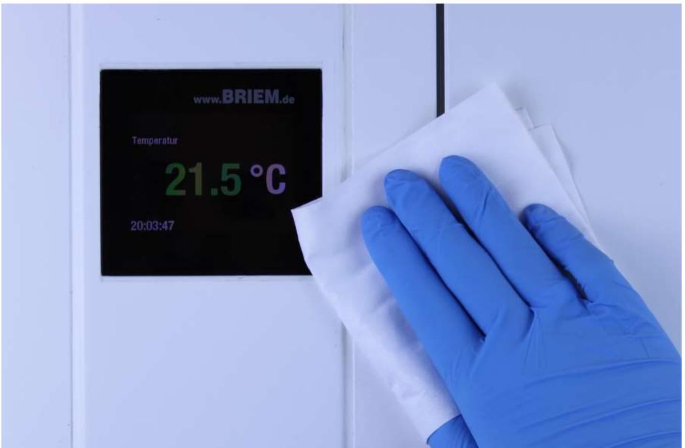
Um den verschiedenen Phasen im Produktionsprozess gerecht zu werden, kann das Reinraum-Monitoring in verschiedenen Profilen gefahren werden. Dazu zählt auch ein Profil für die Reinigung. In diesem Profil sind spezielle Grenzwerte für die Reinigung hinterlegt um unnötige Fehlalarme zu vermeiden.
