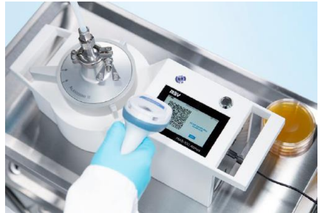
Probenahmedaten werden via Barcodeleser an eine LIMS- oder EM-Software gesendet.
