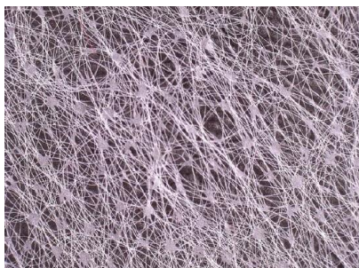
Abb. 1 Faservlies unregelmässiges Rastermass 0.319 – 0.462 mm, / Maschenöffnungen 0.080 – 0.168 mm 2
